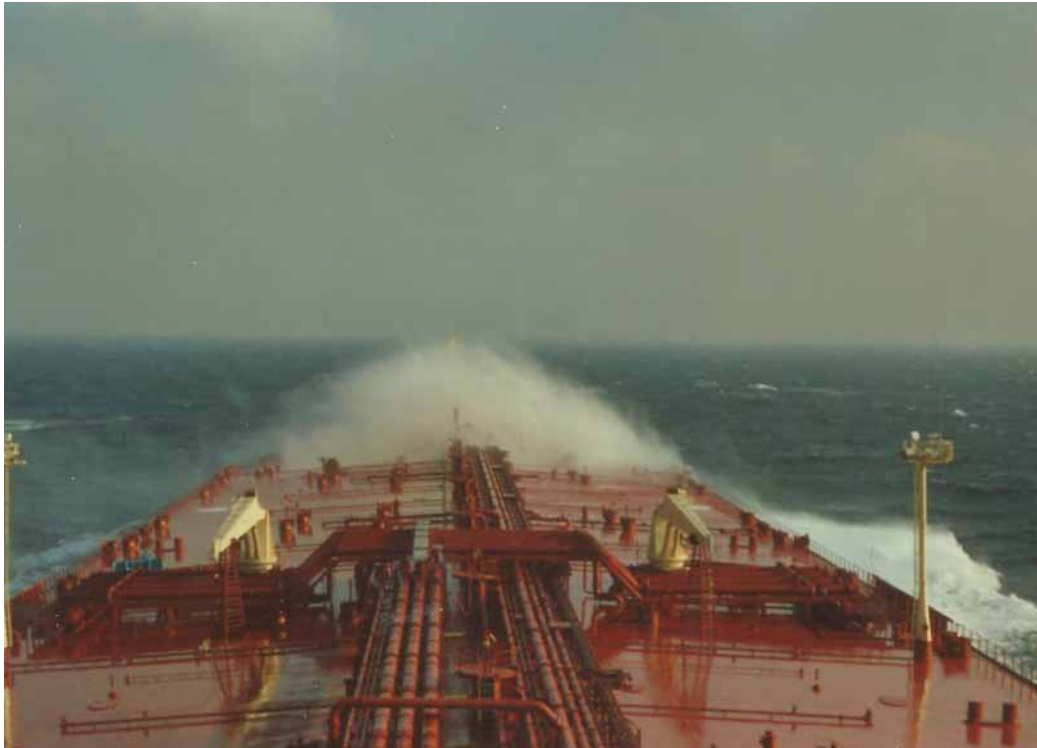
Eleo Mærsk i stormvejr i Biscayen, slangekranerne type HCC 400, ses på tankdækket. Foto: Privat.
