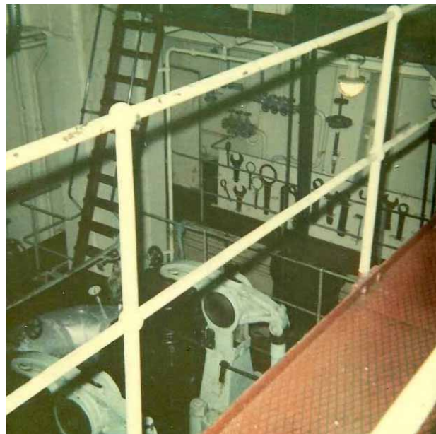
Maskintoppen med hovedmotorens udstødningsventiler og vippearne. Foto: Privat.
