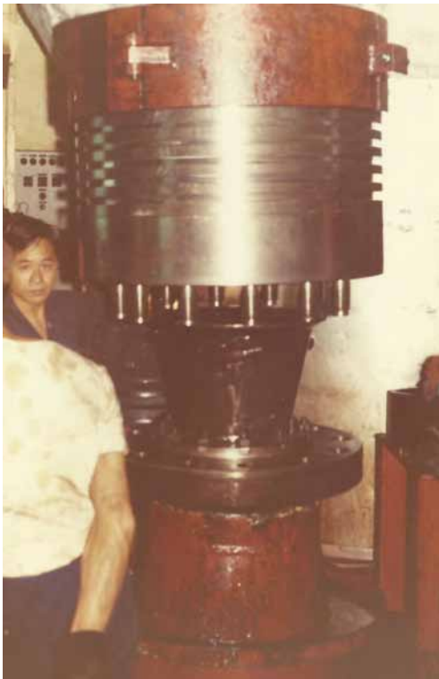
Montering af stempelhoved på stempelstang Foto: Privat.
