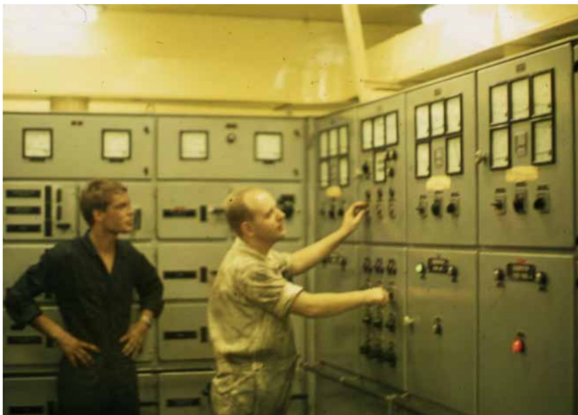
Maskinaspirant Anker Drejer instrueres i at sætte generator ind på hovedtavlen. Foto: Privat.
