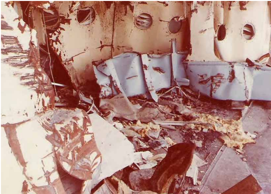
Billede af skaden på hoveddækket, ankeret fra Don Herman II ses nederst i billedet. Foto: Privat.
