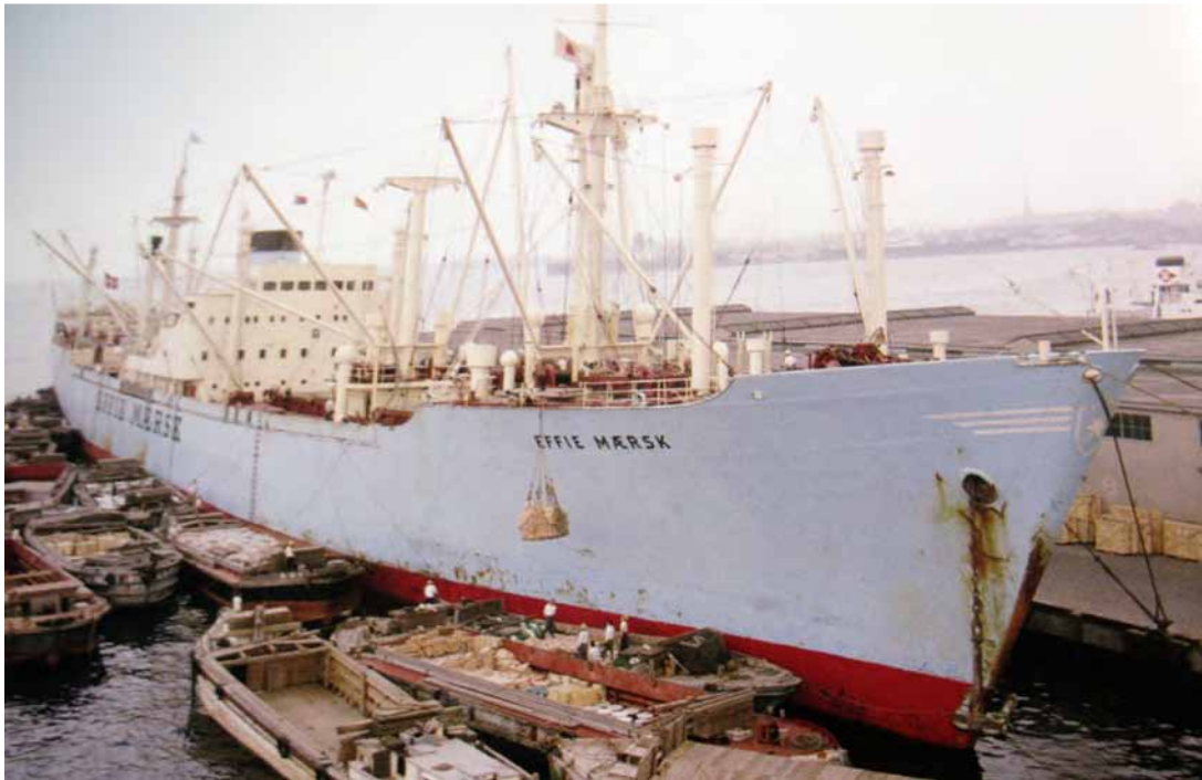
Effie Mærsk bygget i 1955 på Odense Stålskibsværft, var udrustet med lastkøleanlæg, med seks køle/ fryselastrum. I 1965 blev Effie på værft i Japan forlænget med 11 meter. Foto: A.P.Møller.
